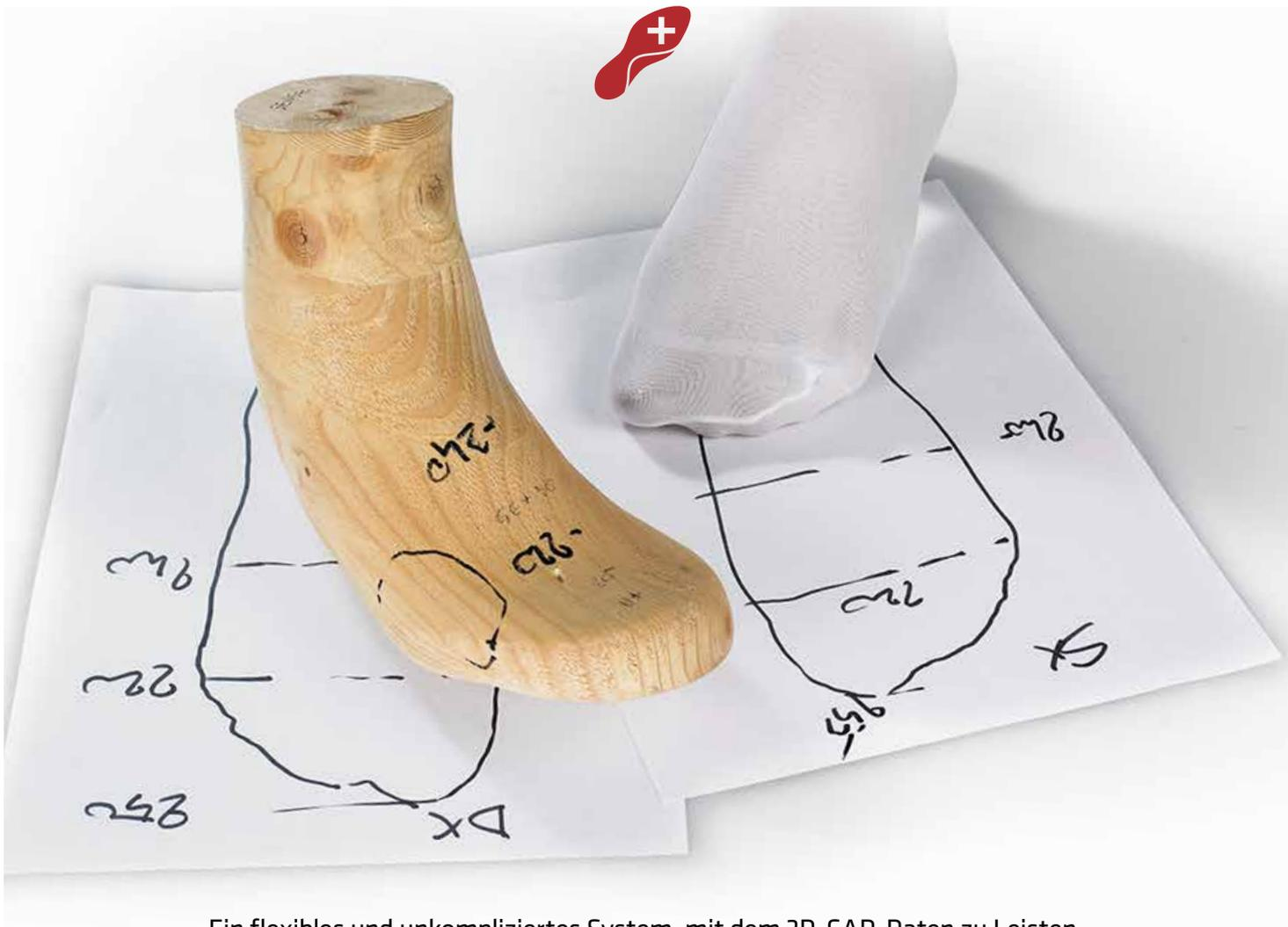
Ein flexibles und unkompliziertes System, mit dem 3D-CAD-Daten zu Leisten und Schuhen an die Anforderungen eines individuellen Patienten angepasst werden können. Aus einer „Leistenbibliothek“ ausgewählte Leisten können einfach an die erforderlichen Formen und Abmessungen angepasst werden. Schuhstile und vollständig entwickelte Muster können direkt auf die neue Leistenform übertragen und daran angepasst werden.
